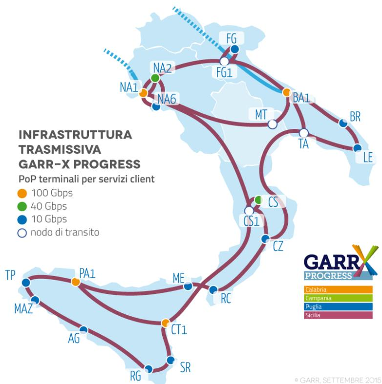
Figura 12: Mappa dell'infrastruttura trasmissiva realizzata in GARR-X Progress
